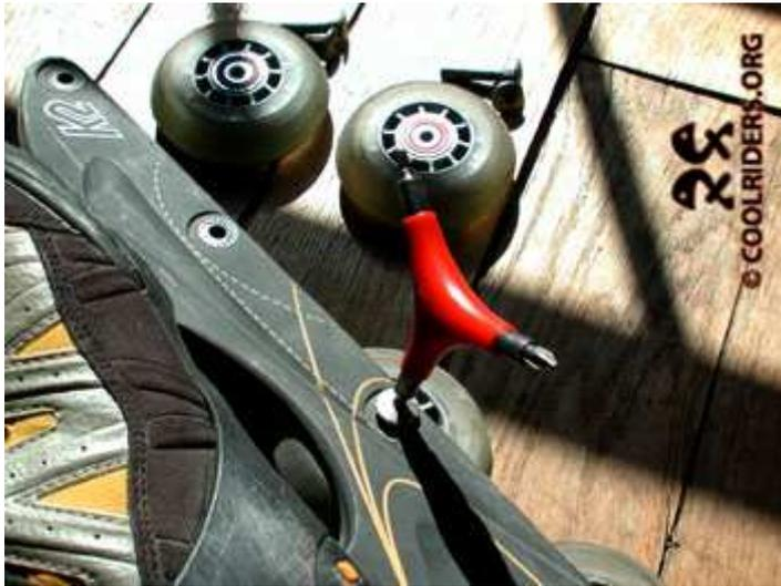
ensuite il faut démonter les roulements des roues (en poussant) à l'aide d'une clé dite en té :
