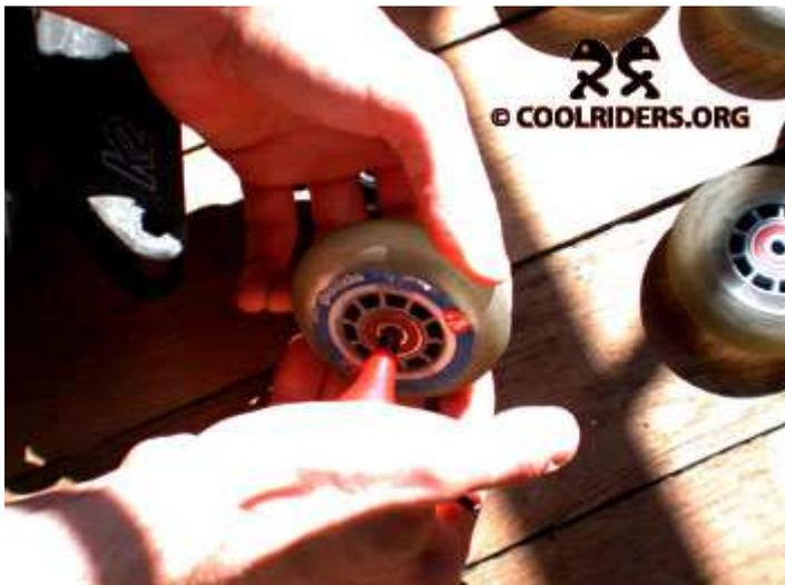
une fois les roulements démontés des roues, nettoyer les roues à l'eau et produit vaisselle (mais pas trop) puis démonter les roulements pour les dégraisser avec un produit type essence c'est (assez volatile pour qu'il n'y ai pas de résidu avant graissage) non corrosif pour les plastics :
